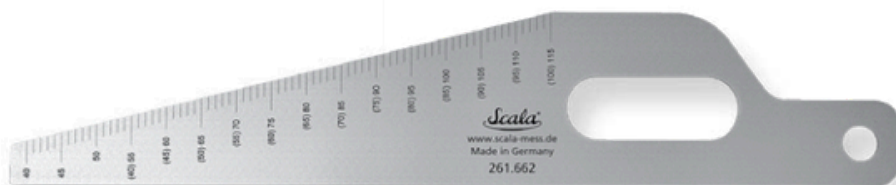
Měřicí klín / kontrolní měrka s oboustranným duplexním dělením pro měření příčného odstupe kluzných čelistí na dvojkolí 40 – 115 mm při šířce pružnicového domku 90 mm, 40 – 100 mm při šířce pružnicového domku 120 mm (Art.-Nr.: 261.662)
